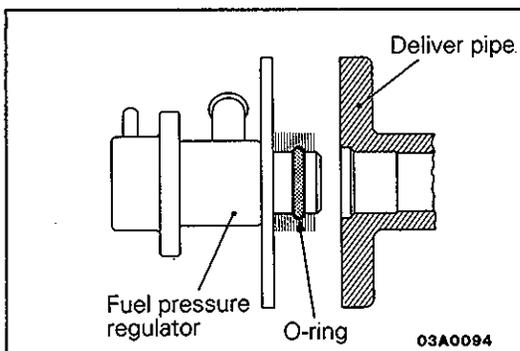
**5. INSTALLATION OF FUEL PRESSURE REGULATOR**
