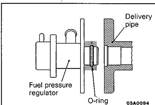
**5. INSTALLATION OF FUEL PRESSURE REGULATOR**
