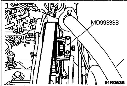
**12./13. REMOVAL OF FUEL INJECTION PUMP SPROCKET AND FUEL INJECTION PUMP**
