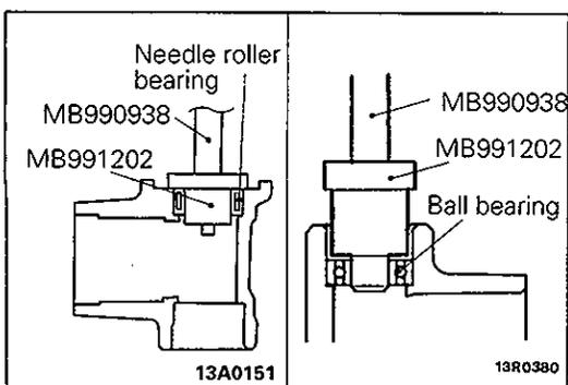
**33. INSTALLATION OF NEEDLE ROLLER BEARING/32. BALL BEARING**
