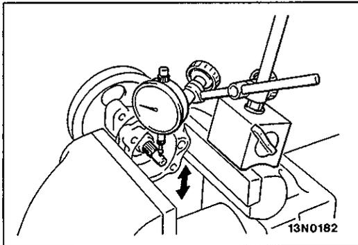
**CLEARANCE BETWEEN SHAFT AND PUMP BODY**
