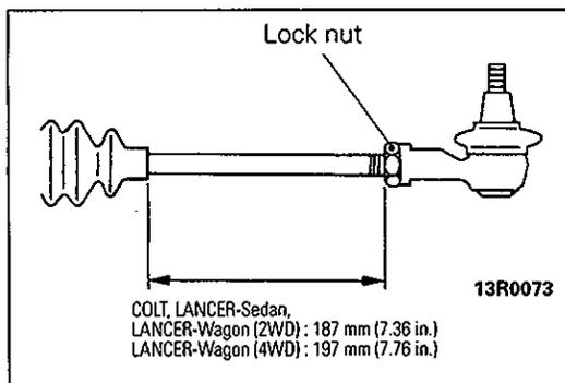
**2. INSTALLATION OF TIE-ROD END/1. TIE-ROD END LOCKING NUT**
