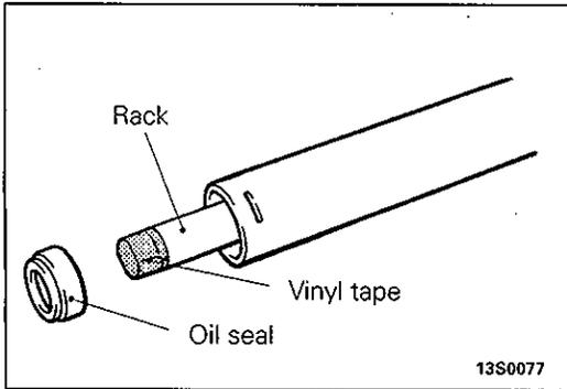
**27. INSTALLATION OF OIL SEAL/25. RACK STOPPER**
