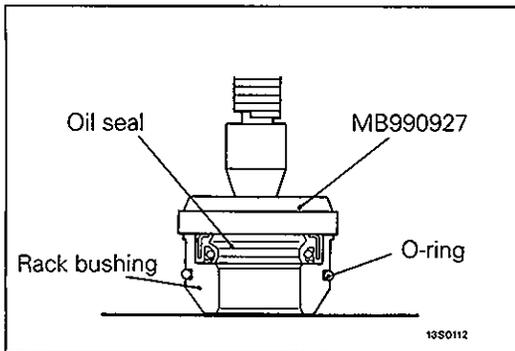
**27. INSTALLATION OF OIL SEAL/26. RACK BUSHING**
