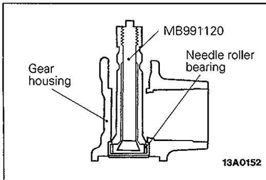
**33. REMOVAL OF NEEDLE ROLLER BEARING**
